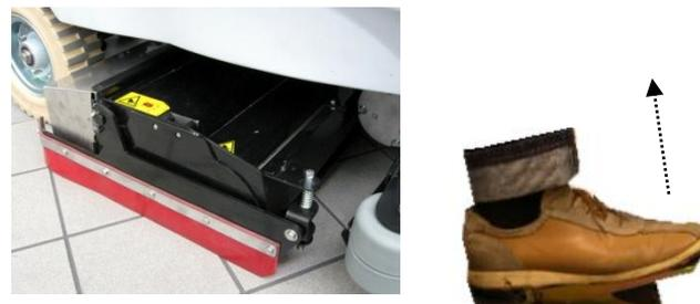
Предохраняет щетку от износа и защищает деликатные поверхности. Щетка останавливается автоматически (с задержкой 3 секунды)
