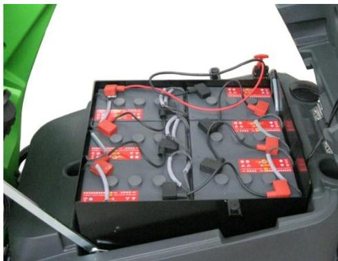
Большой отсек для аккумуляторов позволяет установить аккумуляторы емкостью 320 Ач (время работы 4,5 часов)
