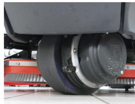
Колесо диаметром 100 мм из не пачкающей резины.
