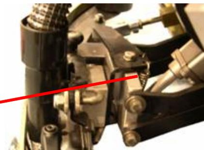
Балка защищена также от ударов в вертикальной плоскости благодаря двум пружинам, которые соединены с актуатором.
