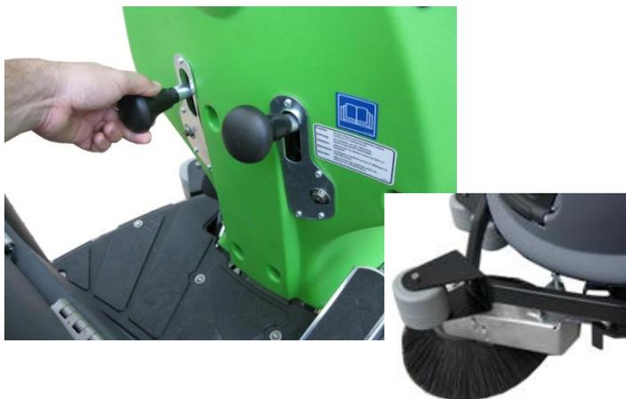
Боковые щетки активируются простым рычагом в нижней части панели управления
