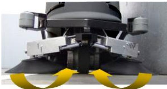
Комбинированная система подметания и мойки с роликовой щеткой обеспечивает наилучший результат на любом покрытии, особенно если нужно осуществлять уборку около стен.
