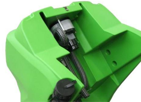
Турбина Ametek легко демонтируется отворачиванием трех болтов и расстыковкой разъема.
