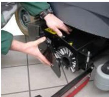
4) Снять прижимную пластину
